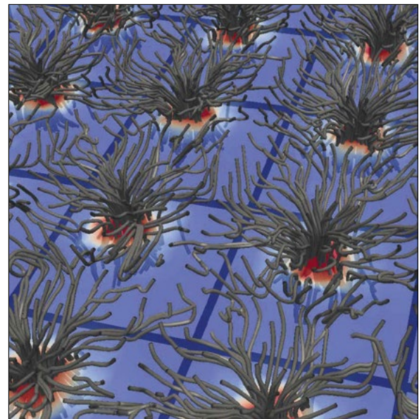
Figure 2. Trajectoires moyennes de diffusion des interstitiels (courbes grises) vers le centre des dislocations (quadrillage en bleu foncé). La concentration de défauts au niveau de l'interface est représentée par le dégradé de couleur.
