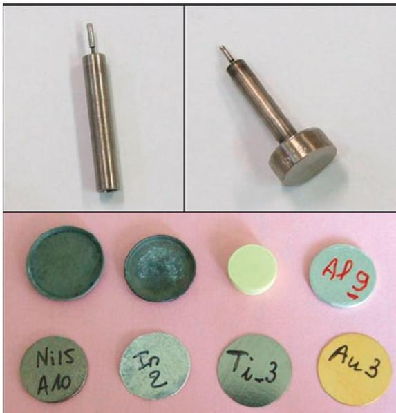
Figure 2. Exemple de chambres à fission et de cibles d'activation utilisées pour la caractérisation du spectre en neutrons.
