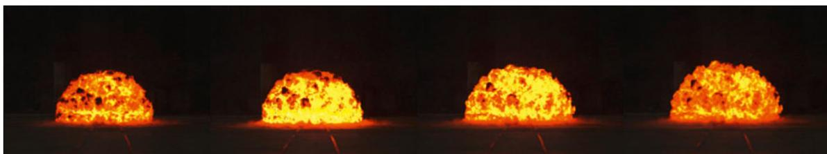
Figure 1. Développement d'une boule de feu au voisinage de sa taille maximale (charge hémisphérique au sol ; images espacées de 1 ms). Les structures visibles à la surface sont le résultat d'instabilités liées au mélange turbulent entre gaz de détonation et air.
