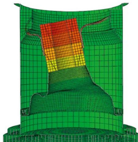
Figure 1. Photographie de l'enveloppe externe et du colis central de la maquette Harmonie (en haut) et représentation en coupe du modèle éléments finis, déformé selon le premier mode transverse à 135 Hz (en bas).
