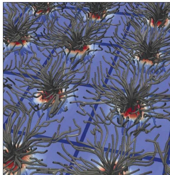
**Figure 2.** Trajectoires moyennes de diffusion des interstitiels (courbes grises) vers le centre des dislocations (quadrillage en bleu foncé). La concentration de défauts au niveau de l'interface est représentée par le dégradé de couleur.
