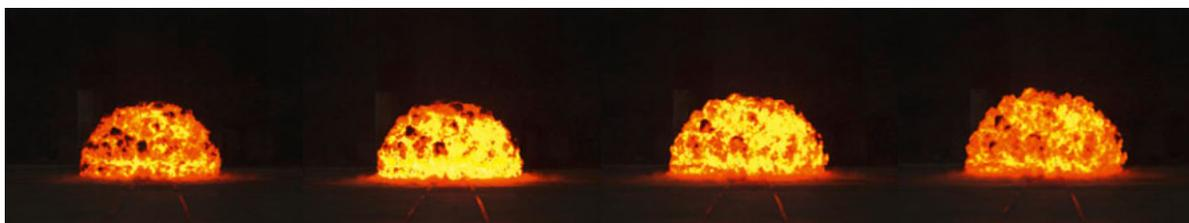
Figure 1. Développement d'une boule de feu au voisinage de sa taille maximale (charge hémisphérique au sol ; images espacées de 1 ms). Les structures visibles à la surface sont le résultat d'instabilités liées au mélange turbulent entre gaz de détonation et air.
