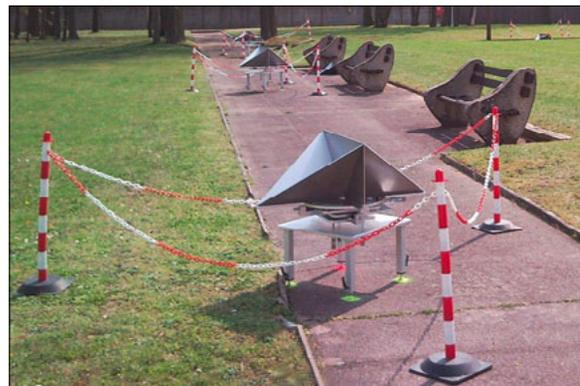
Figure 1. Dispositif expérimental montrant les réflecteurs MUSE sur leurs platines mobiles.
