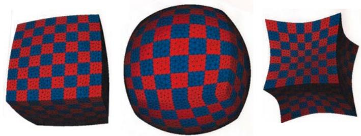
Figure 1. Maillages de formes quelconques dérivées du cube, les couleurs rouge et bleu montrent l'alternance de blocs élémentaires de deux matériaux pouvant être choisis arbitrairement différents. Les axes de symétries d'ordre 3 et 4 sont toujours conservés.
