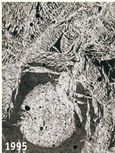
*Martensite  $\alpha'$  monoclinique d'un alliage de plutonium obtenue à -132°C à partir de la phase cubique  $\delta$ .*
