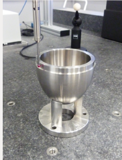
figure 2 Bol JFM, pièce type utilisée pour la qualification du logiciel VCMM.
