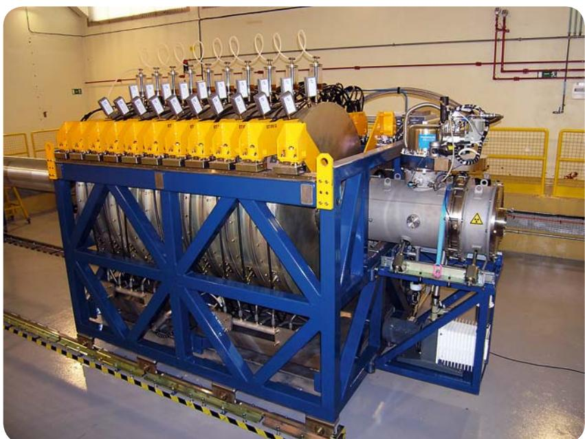
Fig. 2 : Le module LTD 1 MV au CEA-DAM.
